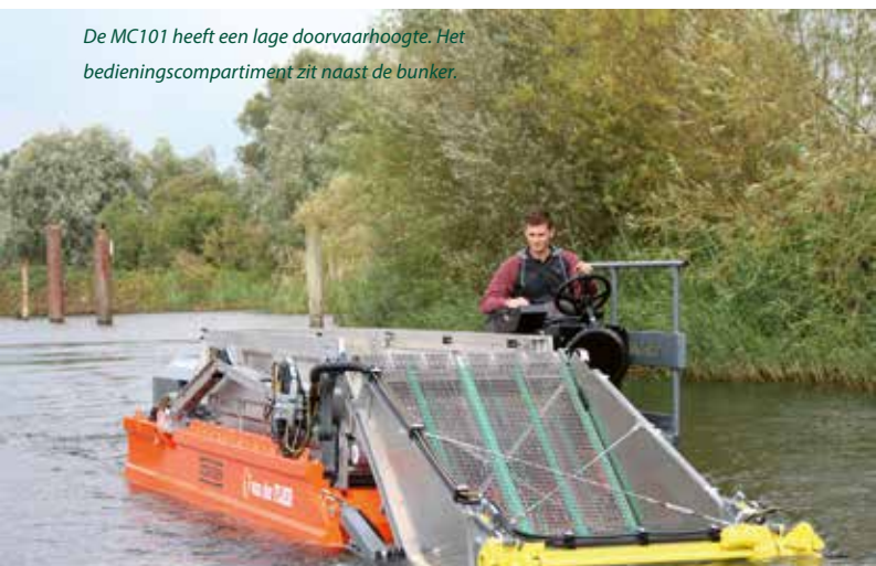
De opvoerband, een doordachte manier om de 'plantenoogst' uit het water te vissen
