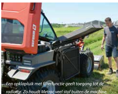
De radiatoren met ventilator kunnen als een deur worden opengedraaid. Dit maakt de motor nog toegankelijker.
