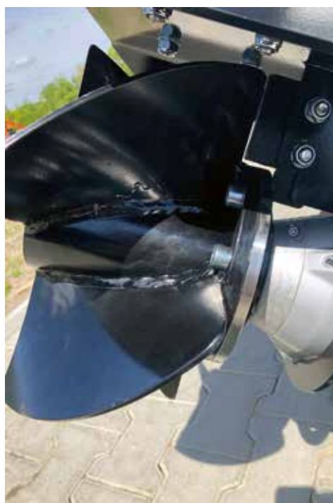
De elektrische aandrijving van schroef met tegenmes.
