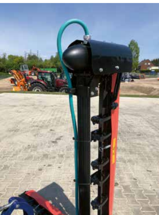
Maaimessen niet meer hydraulisch maar elektrisch aangedreven
