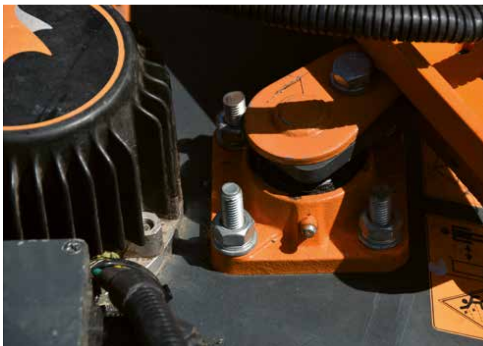
Het lager dat de maaiaarm enige horizontale en verticale bewegingsvrijheid geeft
