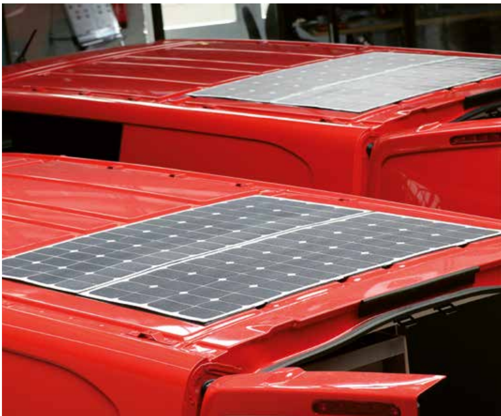
Zonnecellen met een vermogen van zo'n 1.000 wattpiek op de nieuwe werkbussen voorzien de Zeliox van stroom.
