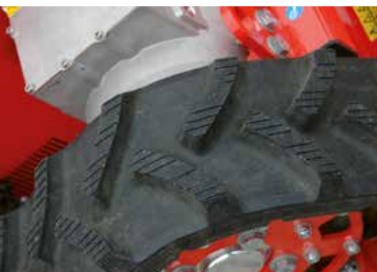
Mogelijkheid om rupsbanden met tractorprofiel te monteren. Deze geven de Agria 9600 extra grip
