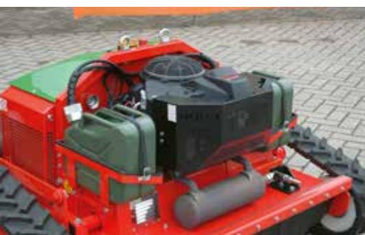
Een Kawasaki 2-cilinder 726 cc 4-taktmotor, de FS730 V EFI, drijft de hybride machine aan. De brandstof in de twee jerrycans wordt gelijkmatig verbruikt
