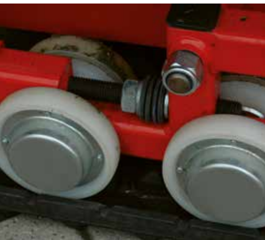
Stalen kappen op de wielnaven van de begeleidingsrollen
