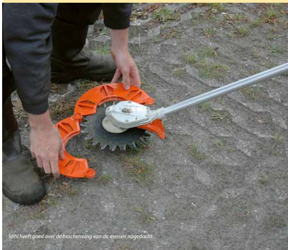
Je ziet hier duidelijk het verschil in tanden bij het onder- en bovenblad van de Ego.
