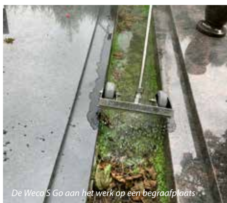
De temperatuur van Weco-machines is constant bijna 100 graden Celsius.
