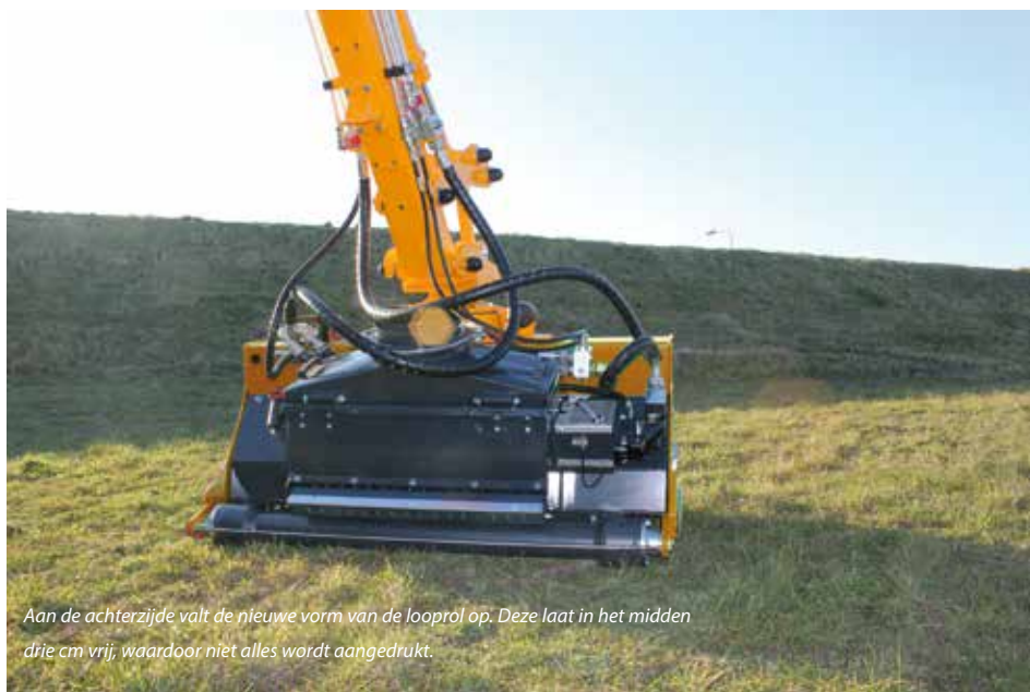
Het hart van de Ecochopper wordt gevormd door vier maaischijven, een rotor met vrij draaiende mesjes en een tegenkam met mesjes.
