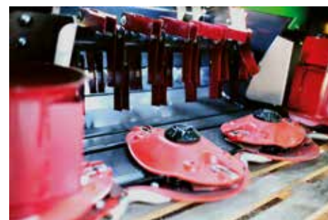
Het hart van de Ecochopper wordt gevormd door vier maaischijven, een rotor met vrij draaiende mesjes en een tegenkam met mesjes.
