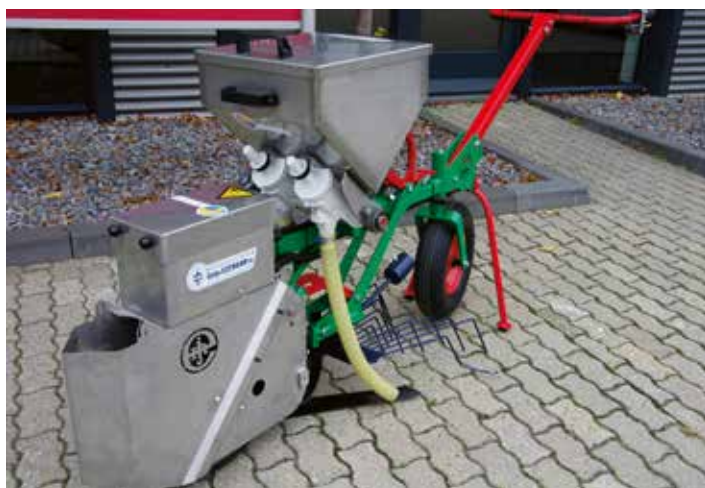
Naast wieden en schoffelen leent de werktuigdrager zich bijvoorbeeld voor rijenbemesting met granulaat.
