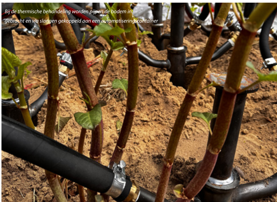
Het systeem met stoomplaat en lansen werkt uitstekend voor droge zandgronden
