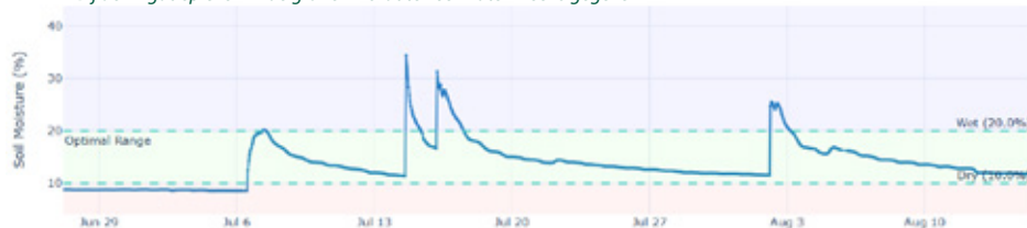
Bij de irrigatiepieken in de grafiek wordt te veel water ineens gegeven
