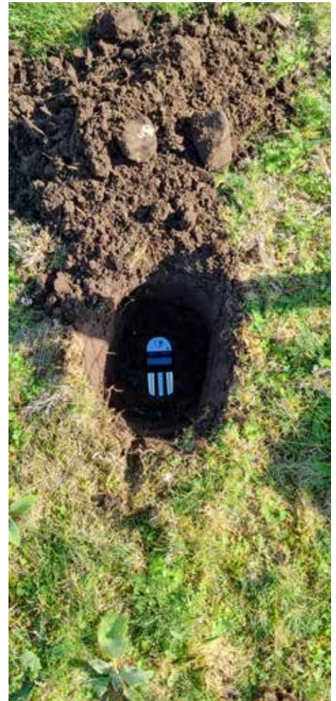
Met de schop worden de sensoren in de bodem aangebracht op gemiddeld 30 cm diepte. Via een zender zijn de sensoren verbonden met het basisstation.
