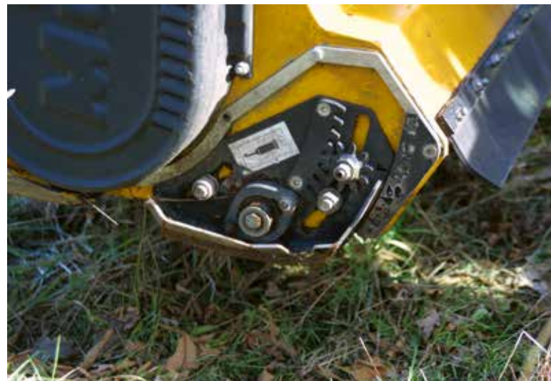
De maaihogte is met dit robuuste systeem heel eenvoudig in te stellen.
