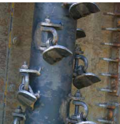
De spiraalvormig aangebrachte M-klepels zijn gemakkelijk te vervangen.
