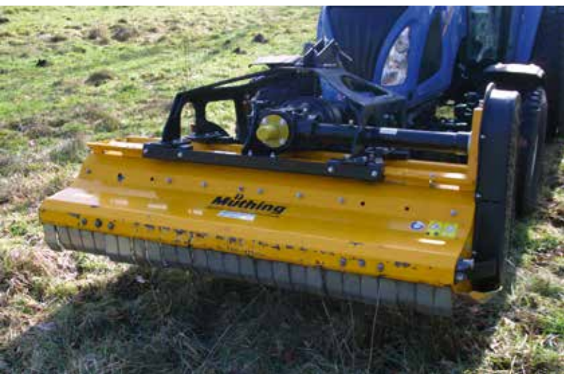
Mechanisatiebedrijf Wevers verzorgde de frontaankoppeling van de aftakas-aangedreven klepelmaaier met Zuidberg-materiaal, compleet met snelkoppelingen voor de hydraulica.
