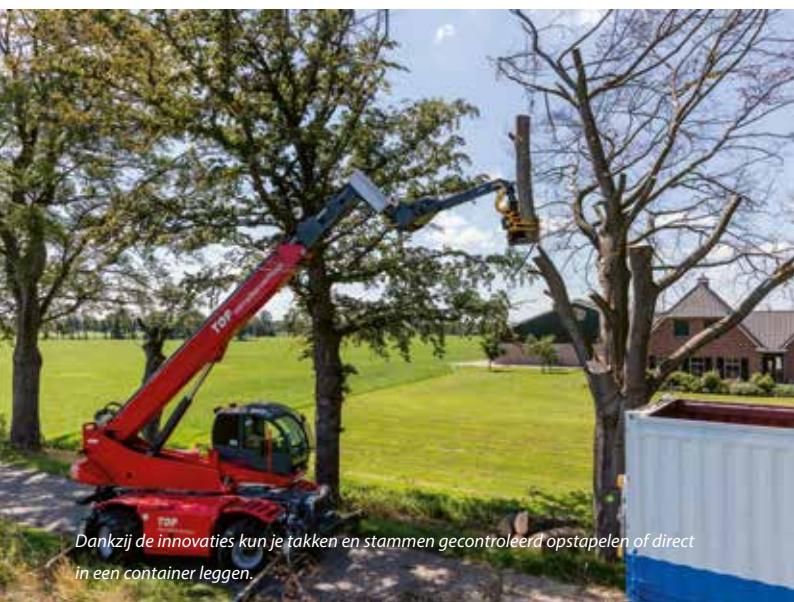
Met Gierkinks velkop gemonteerd achter een kraanwagen is werken in de stad gemakkelijk en veiliger.
