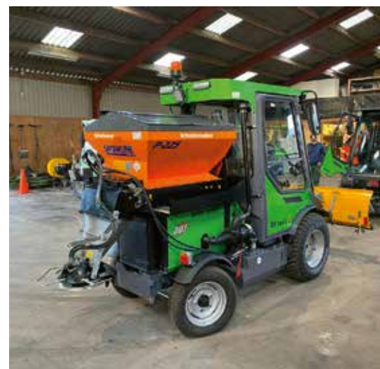
Ook ombouwen naar winterdienst gaat vrij eenvoudig bij deze werktuigdrager.
