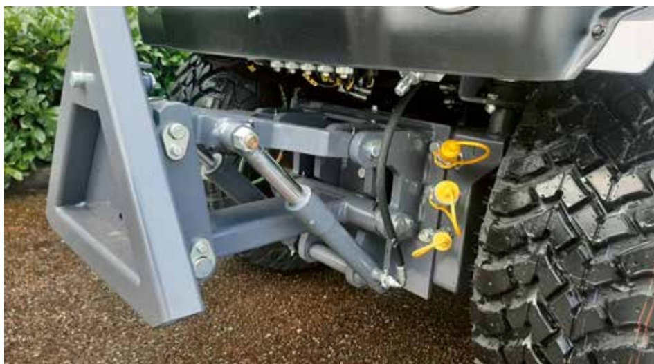
Het ontwerp van het hefsysteem met een snelwissel-A-frame werd vernieuwd.
