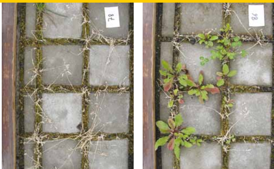
Figuur 5 – Invloed van het straatlaagmateriaal op veronkruiding. (Voegvulling van vervuilde kalksteen 0/6,3 in 11 mm voeg).
