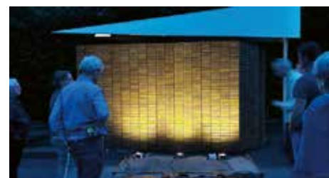
In een testopstelling in Ameide is uitgebreid geëxperimenteerd om de juiste grondspots te vinden en toe te passen.
