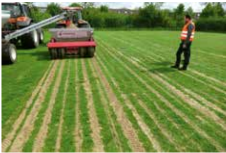
Er werden zogenaamde zandlamellen aangebracht door de Vibra Sandmaster. (Foto: Lucienne Weststrate)
