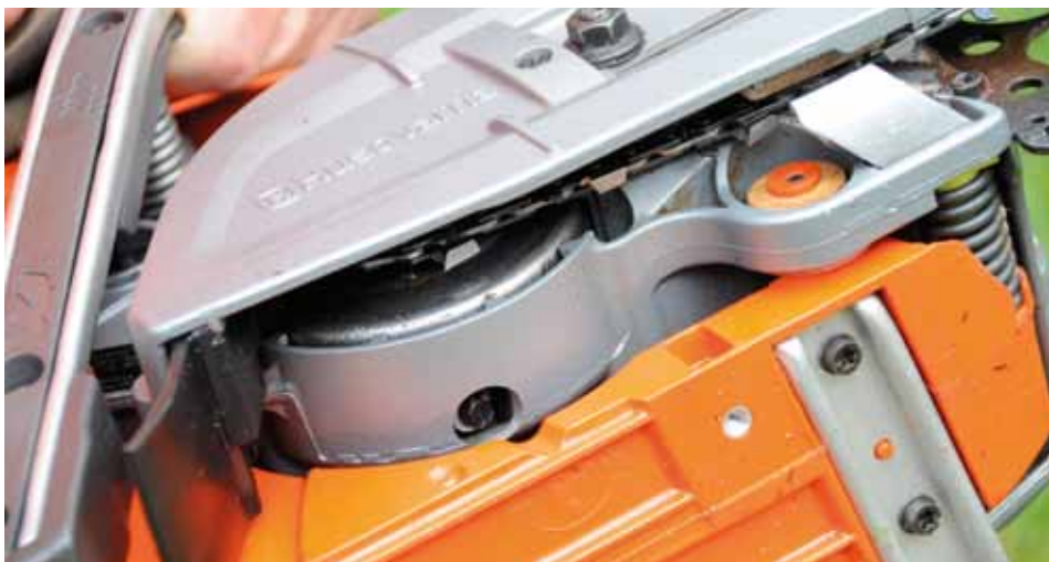
Ruime opening om zaagsel te lossen.
