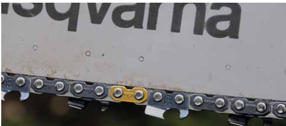
De goudkleurige schakel is handig bij het slijpen van de machine.
