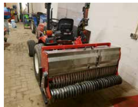
De 32 speciaal vormgegeven aandrukwielen dragen bij aan kwaliteitszaaiwerk.
